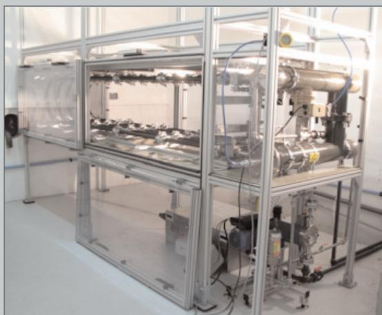
Test de résistance chimique sous contrainte
